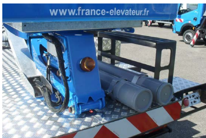
FEU SOUS PANIER - RANGEMENT PANNEAUX SOUPLES
