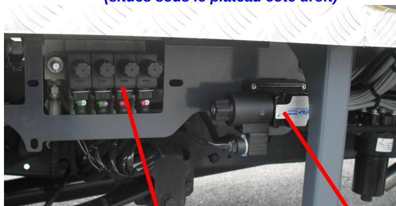
BLOC DE COMMANDE STABS + VANNE BYPASS (situés sous le plateau coté droit)
