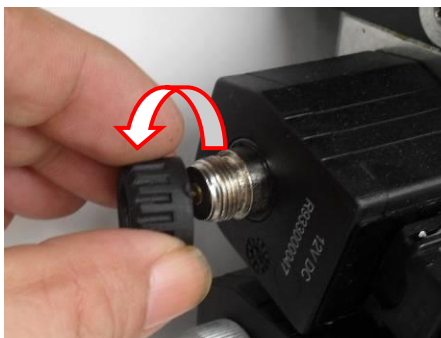
Dévisser l'écrou de blocage du distributeur
