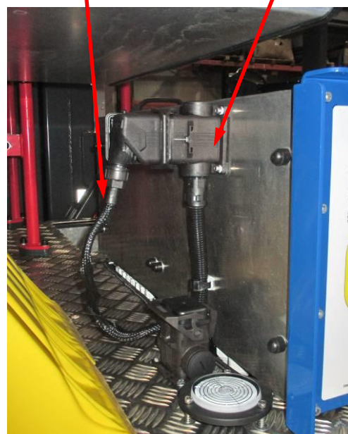
Câble "châssis" connecté à la broche sur le coffre droit
