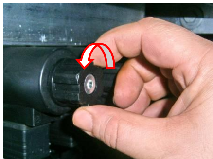
Dévisser l'écrou de blocage
