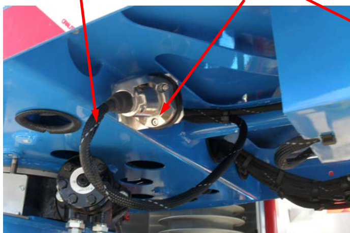
Câble « panier » connecté à la broche située sous le panier = Utilisation de la batterie en mode travail
