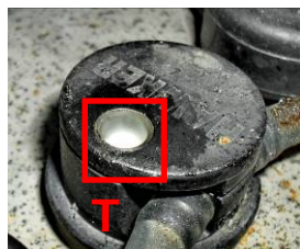
Indicateur de niveau Flotteur blanc visible = Niveau d'électrolyte OK
