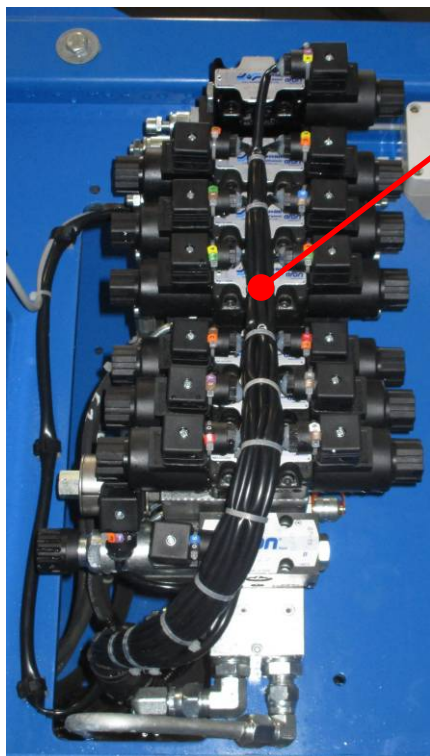
BLOC DE COMMANDE BRAS ELEVATEUR (situé sur le flanc latéral de la tourelle)
